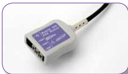
Módulo ExG para obter EEG, EOG, EMG, ECG. (máximo de 3 canais)
