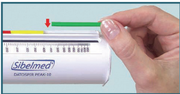
Herramienta de autocontrol (semáforo) / Colour-Zone system
